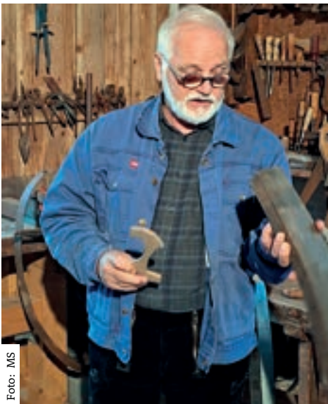
Uwe Oldach erklärt die Form einer Fassdaube mit Hilfe der passenden Schablone
