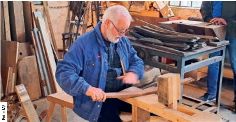
Uwe Oldach demonstriert die Funktionsweise der selbst gebauten Schnitzelbank
