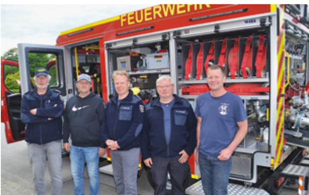
Das neue Feuerwehrfahrzeug der Drei-Gemeinde-Wehr Hude-Fresendelf-Süderhöft wurde jetzt der Einwohnerschaft vorgestellt. Es ist ein Fiat-Iveco, wiegt 6080 kg, verfügt über Notstromaggregat, Rettungsrucksack, ausfahrbaren Lichtmast, vierteilige Steckleiter und führt 750 Liter Wasser mit. Hudes Bürgermeister Jens Heldt: „Die Beschaffung hat zwei Jahre gedauert.“
